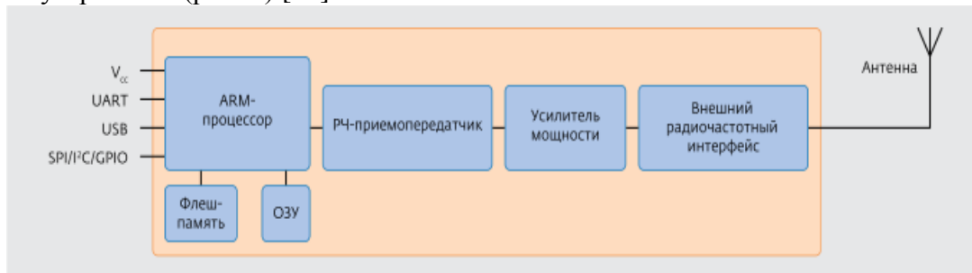
Рис. 3. Структура передачи сигналов
