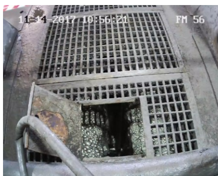
Рис. 1. Вид рабочего пространства для наблюдения за потоком пенного продукта во флотационной машине
