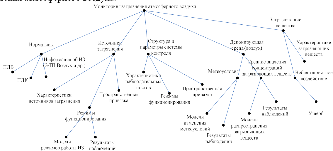
Рис. 1. Семантический граф понятий применительно к мониторингу загрязнения атмосферного воздуха (ИЗ – источник загрязнения)
