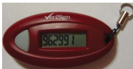
Рис. 1. Простейший токен, отображающий сгенерированный пароль на дисплей
