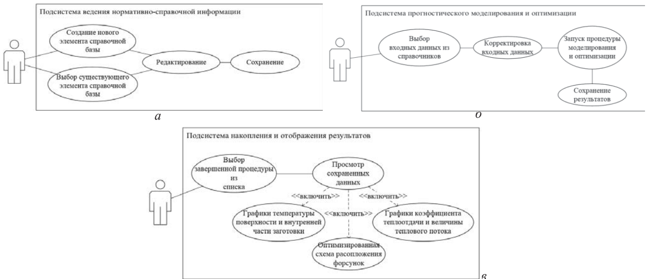
Рис. 2. Диаграммы сценариев взаимодействия пользователя с интерактивной системой автоматизации проектирования схемы расположения форсунок: а) ввод и редактирование нормативно-справочных данных, б) запуск процедуры прогностического моделирования и оптимизации, в) анализ накопленных данных, представляемых в графическом и текстовом виде на диалоговых формах
