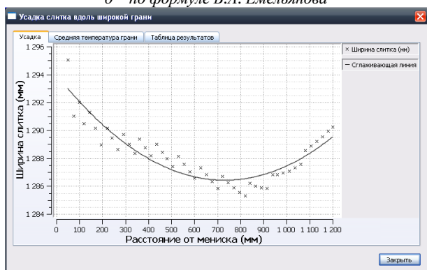
Рис. 3. Размер широкой грани слитка по высоте кристаллизатора при расчете теплового потока по формуле (1)
