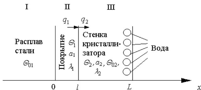
Рис. 1. Термодинамическая система «расплав металла – покрытие – стенка кристаллизатора»
