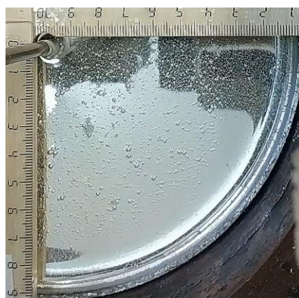
Рис.3. Пузырьки водорода на свободной поверхности жидкого металла.
